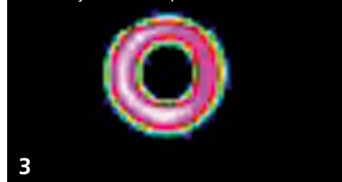
Falschfarbenbild eines Laserstrahlhärteprozesses mit ringförmigen Laserstrahlflecken, aufgenommen mit dem System »E-MAqS«
