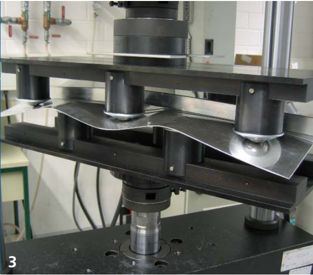
Maximale Biegelast im 10-Punkt-Biegeversuch für verschiedene Stringergeometrien
